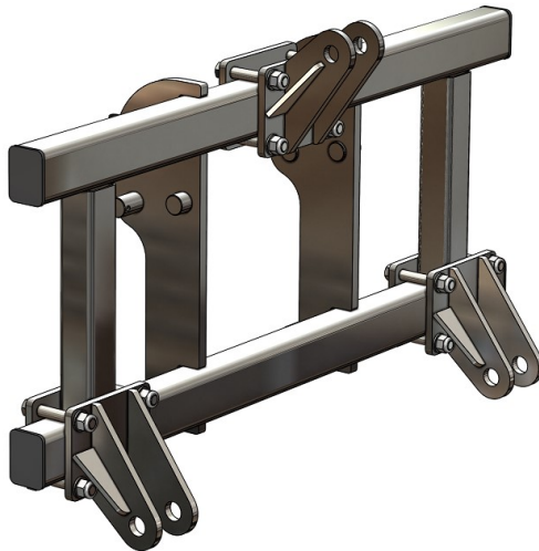
Rys. 8 Ramka zawieszenia z zamontowanym mocowaniem TUZ kat. II
